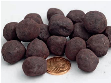
Abb. 54 | Eisenerzpellets für die Stahlproduktion
