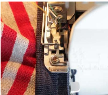
Abb. 92 | Position des Nähguts unter der Overlockmaschine
