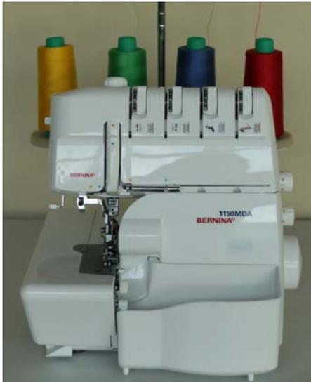
Abb. 89 | Overlockmaschine
